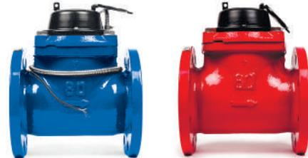
Турбинные ирригационные счётчики используются для учета сточных вод и загрязнённой воды. Приборы справляются со средой, загрязнённой не более чем на 30%. Устанавливаются на объектах сельского хозяйства, очистных установках, в канализационных сетях и точках водозабора из открытых водоёмов.
